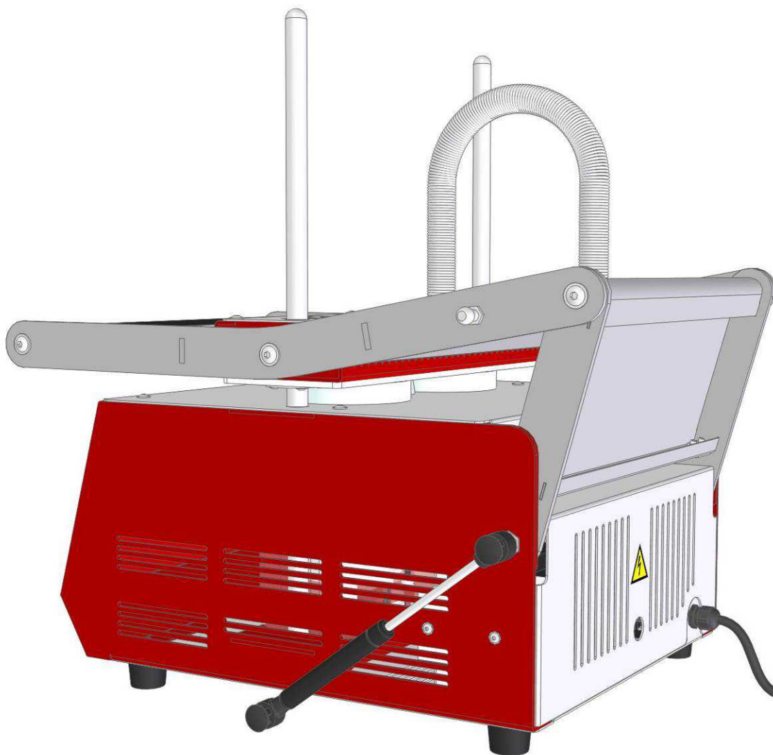
Рис. 3. Установка газовых пружин (на рисунке представлен общий вид аппарата Piramida 2С)
